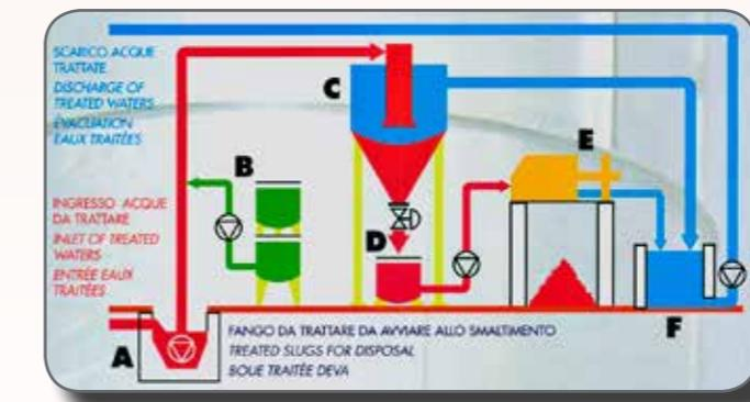
**A)** Pozzetto di raccolta acque reflue con pompa ad immersione
